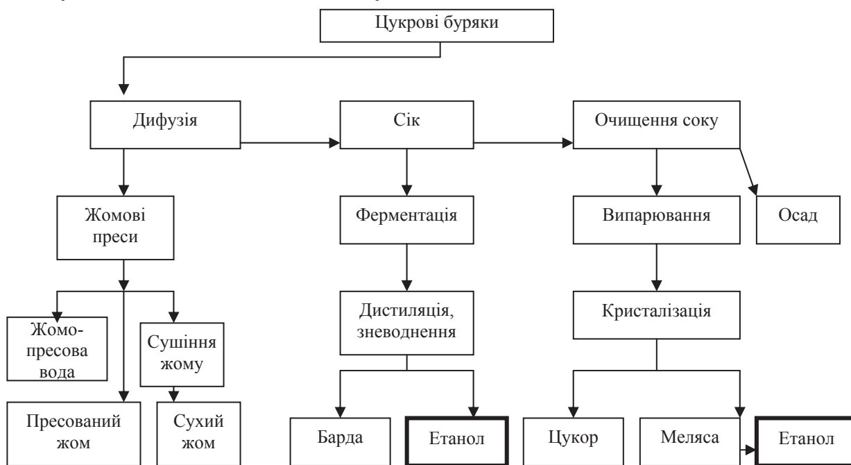
Рис. 2. Схема виробництва біоетанолу з меляси і дифузійного соку
